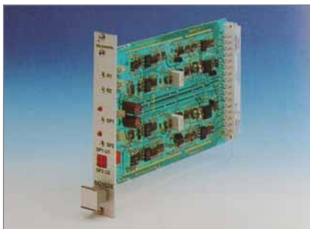
图 222. BG1S30 型信号限制器
