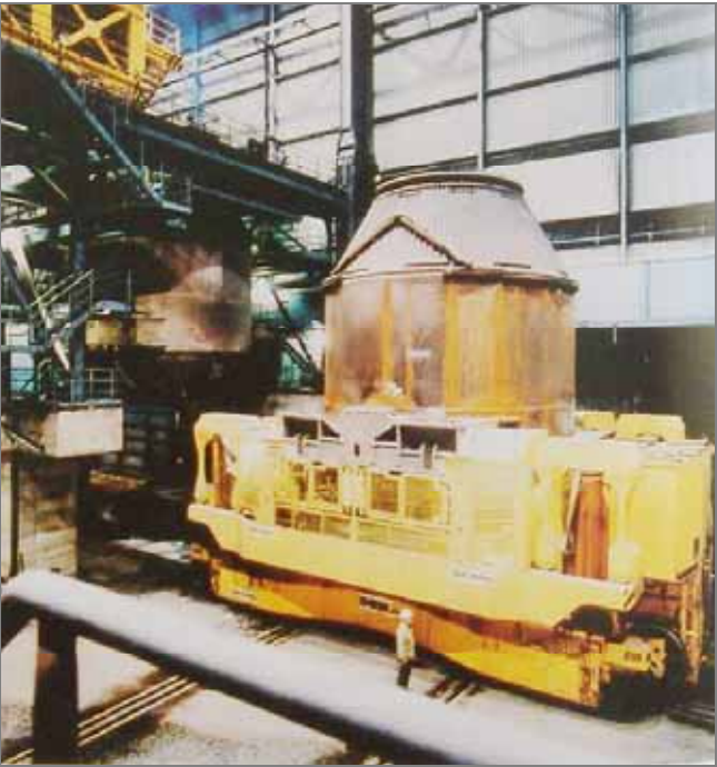
图 277 转炉贮槽更换车通过路轨交叉口运到相应位置
