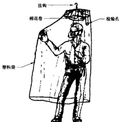
图 E.1 简易定性适合性检验罩
