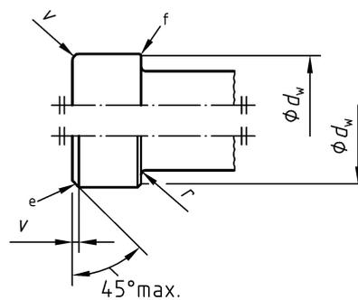
ANMERKUNG Bei gestoßenen Innensechskanten, die am oberen Grenzmaß liegen, dürfen die Schlüsselflächen höchstens über 1/3 ihrer Länge, die  $e/2$  beträgt, von der Bohrung angeschnitten werden.
