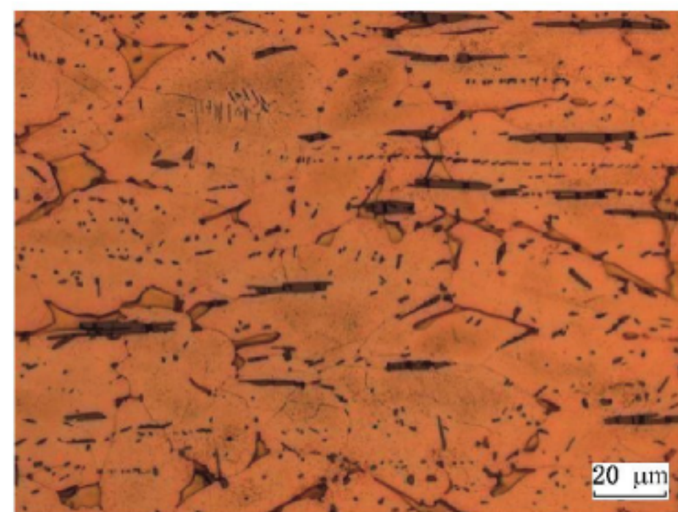
图 A.18 HMn60-3-1.7-1 金相图片(HR50)
