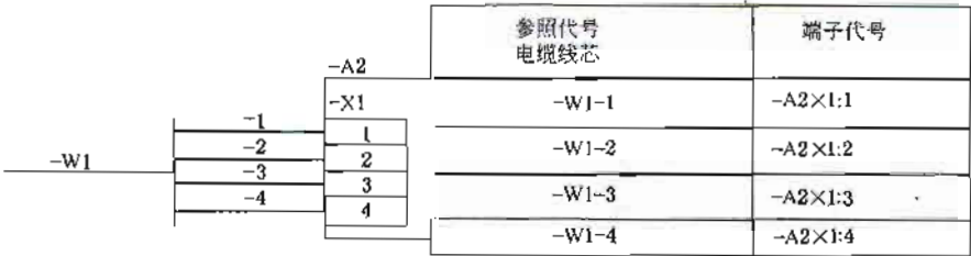
图 79 多芯电缆终端表示方法示例
